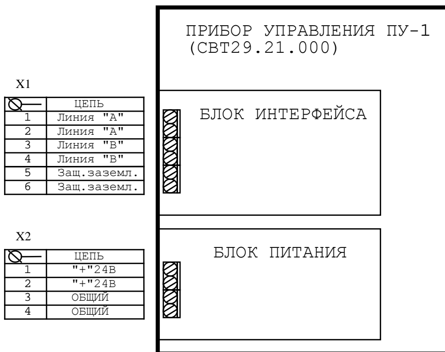
Рис. 6. Клеммные колодки ПУ-1 Подключение ПУ к линии связи с ЦП-1 (ЦП-1М)
